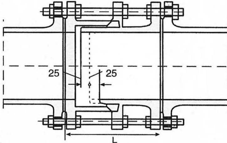
Монтажные вставки Т-КВз (F3) двусторонне укрепленные, компенсационные из сфероидального чугуна. Употребляется при монтаже трубопроводов, монтаже и демонтаже отключающей и регулирующей арматуры.
